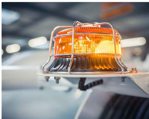
● 2 gyrophares LED Situé à gauche et sur l'enrouleur pivotant, commandé depuis la cabine
